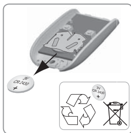
[3]. Извлеките элемент питания с помощью отвертки.
