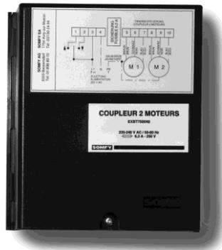
Устройство управления разработано для применения с двумя электроприводами одинаковой модели с электромеханическими конечными выключателями, например, серий LT50/60, устанавливаемыми в один вал. Остановка в конечном положении осуществляется по срабатыванию системы конечных положений одного из электроприводов, при этом на втором электроприводе она находится в режиме настройки. Благодаря этому решению возможно изготовление кассетных маркиз и решёток большой площади
