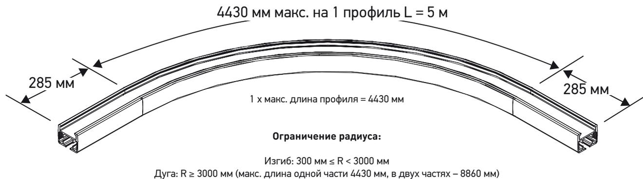
**!** В результате гибки, 285 мм направляющей по обе стороны изгиба или формы закругления по-прежнему остаются прямыми.
