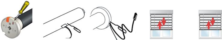
Нажмите и удерживайте нажатой более 7 с кнопку программирования Prog на радиоприёмнике DC RTS Receiver, Power 1 x 2,5 DC RTS или электроприводе RTS.
